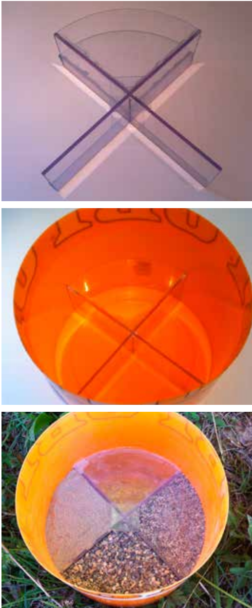
Abb. 2: Vierkammersystem aus Plexiglas inklusive quadratische Startposition der Larve in der Mitte der Konstruktion. Die in Blickrichtung der Larve gelegene Kammer ist mit Plexiglas verschlossen (oben). Behälter inklusive eingebautem Vierkammersystem aus Plexiglas ohne Substrate (Mitte). Behälter gefüllt mit den Substraten Feinsand-Mittelsand-Gemisch, Grobsand und Feinkies (unten).
